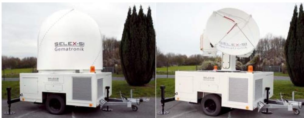
Figura 3 Radar mobile in banda X del DPC
